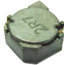
Die geschirmten Leistungsdrrosseln **DM5028/DM5048** wurden speziell als Ausgangsdrrosseln für DC/DC Anwendungen entwickelt. Das verwendete Material (Mn-Zn) sorgt für niedrigen DCR sowie hohe Sättigungsströme. Der Kern wird kopfüber im Schirmbecher zentriert. Der Luftspalt befindet sich somit an der Unterseite, wodurch gute EMV-Eigenschaften erreicht werden.
